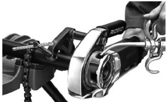
Figure 6 – Filetage des tuyaux et application de l'huile
