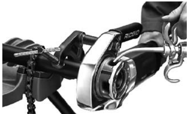
Figura 6 – Aplicación de aceite mientras se rosca un tubo
